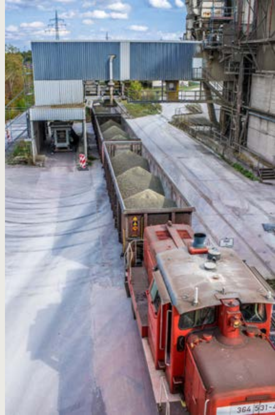
Klinkerverladung in Bahnwaggons, 19.9.2018 (Foto: Steffen Fuchs)
