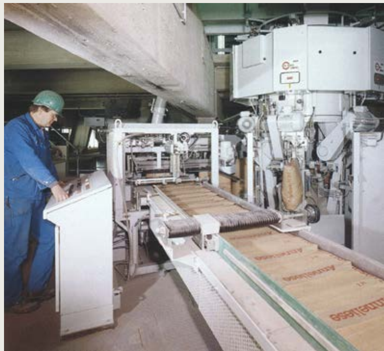
Neue Absackanlage im Zementwerk Atlas mit automatischer Sackzuführung zum Rotopacker, 1989
