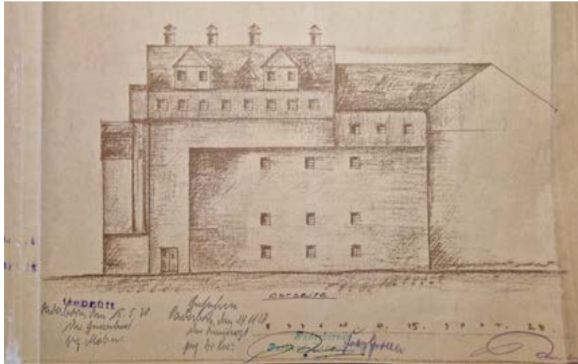
Ostansicht der Erweiterung des Ofenhauses mit vier weiteren Schachtöfen, 1929
