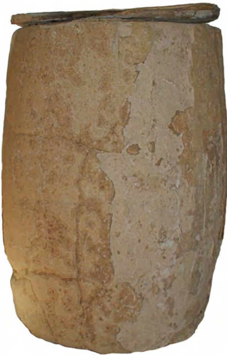
Erhärteter Romanzement aus im Inn gesunkenen Fässern.
