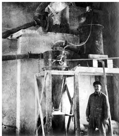
Versuchsentstaubung „Intensiv“ vor einer Staubkammer, ca. 1954
