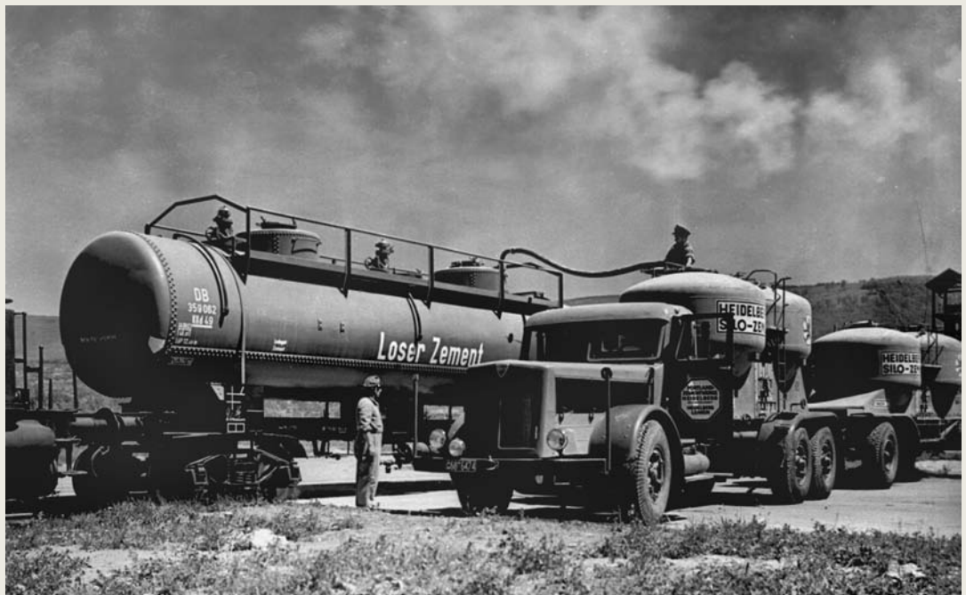
KESSELWAGGON DER DEUTSCHEN BUNDESBAHN bei der Entladung in Silolastkraftwagen, ca. 1955.
