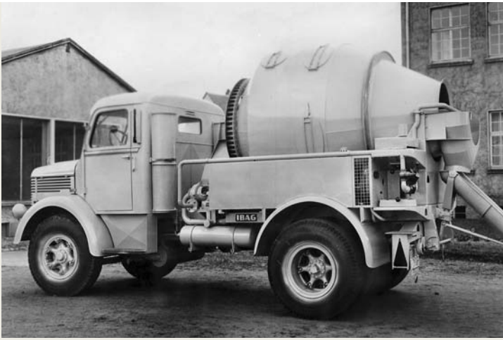
ERSTER TRANSPORTBETONFAHRMISCHER DEUTSCHLANDS, entwickelt von der Internationalen Baumaschinenfabrik AG (IBAG) in Neustadt a. d. W., 1954.
