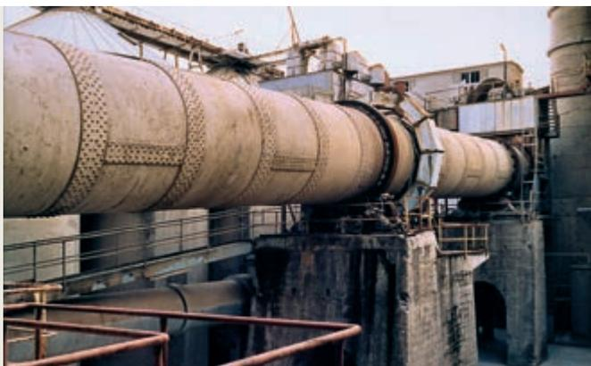
Der **DREHROHROFEN** im Werk Elsa/Rote Erde, 1987.
