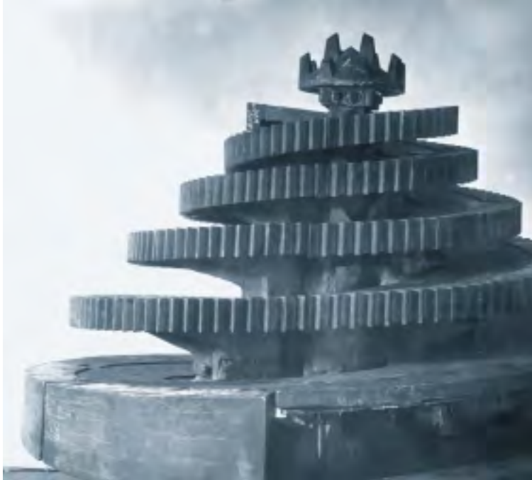
Eigen entwickelter Drehrost zur Entleerung der Schachtöfen, um 1900.
