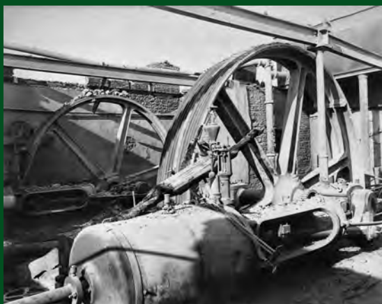
Fast unbeschädigte Sulzer-Dampfmaschinen
